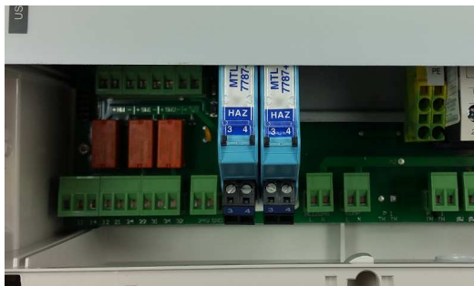
Fig. 2 Aperçu barrières Zener à 1 pompe - sans plaque de séparation -
